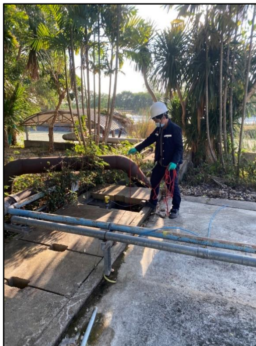
ภาพที่ 3.23 การตรวจวัดคุณภาพน้ำบริเวณน้ำทิ้งจากระบบเอเอส
