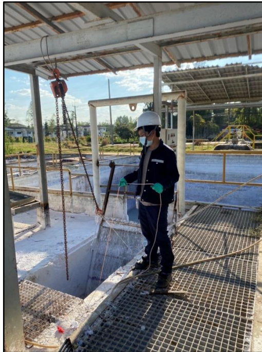
ภาพที่ 3.22 การตรวจวัดคุณภาพน้ำเสียรวมก่อนเข้าระบบบำบัดน้ำเสีย
